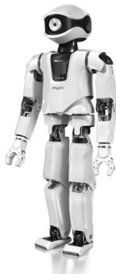
Abbildung 2.1: Der humanoide Roboter Myon ist eine Forschungsplattform, entwickelt und gefertigt im NRL der Beuth Hochschule für Technik Berlin. Myon ist 1,25 m groß und 16 kg schwer [Thi14].[HSB + 11]
